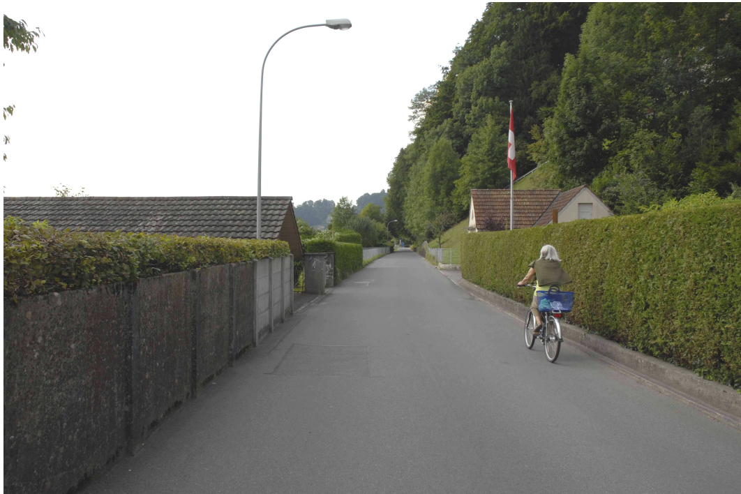
Einfriedungen und Hecken müssen gemäss Strassengesetz zur Fahrbahn einen Mindestabstand von 0.6 m einhalten
