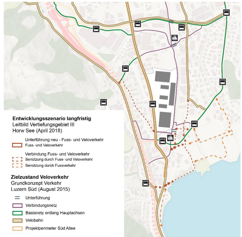
Abbildung 15: Übersicht der geplanten Erschliessung für den Veloverkehr
